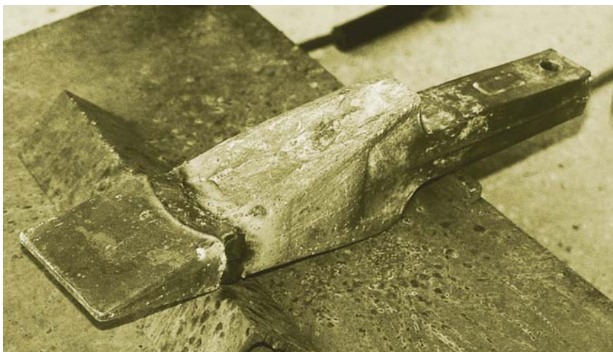
Výměna hrotu zuby lopaty s použitím OK 67.45 nebo OK Tubrodur 14.71
