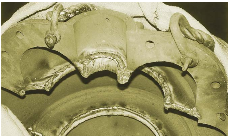
Těleso čerpadla: OK 94.25
