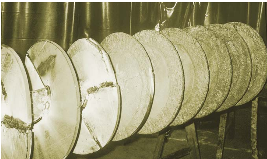
Transportní šnek: navařování OK Tubrodur 14.70
