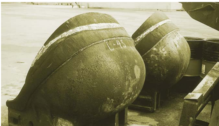
Nové hrany korečků rypadla přivařené elektrodami OK 68.82
