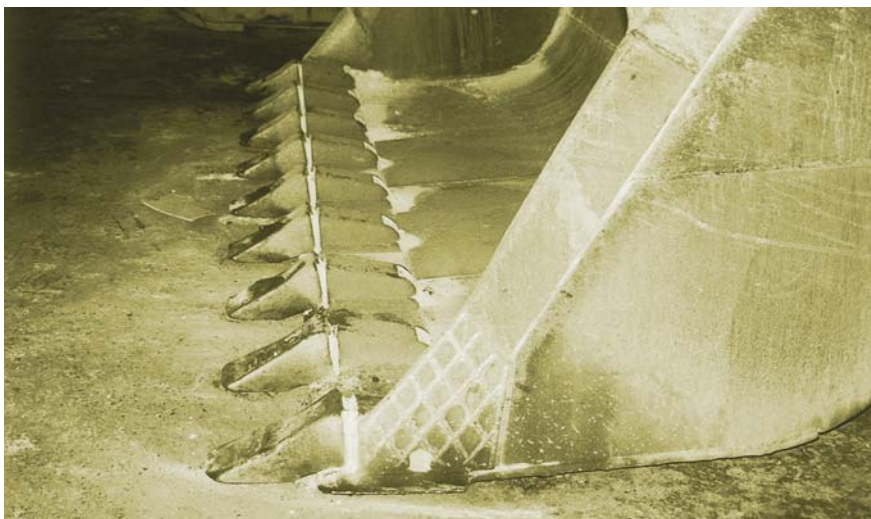
Preventivní navařování elektrodami OK 84.58
