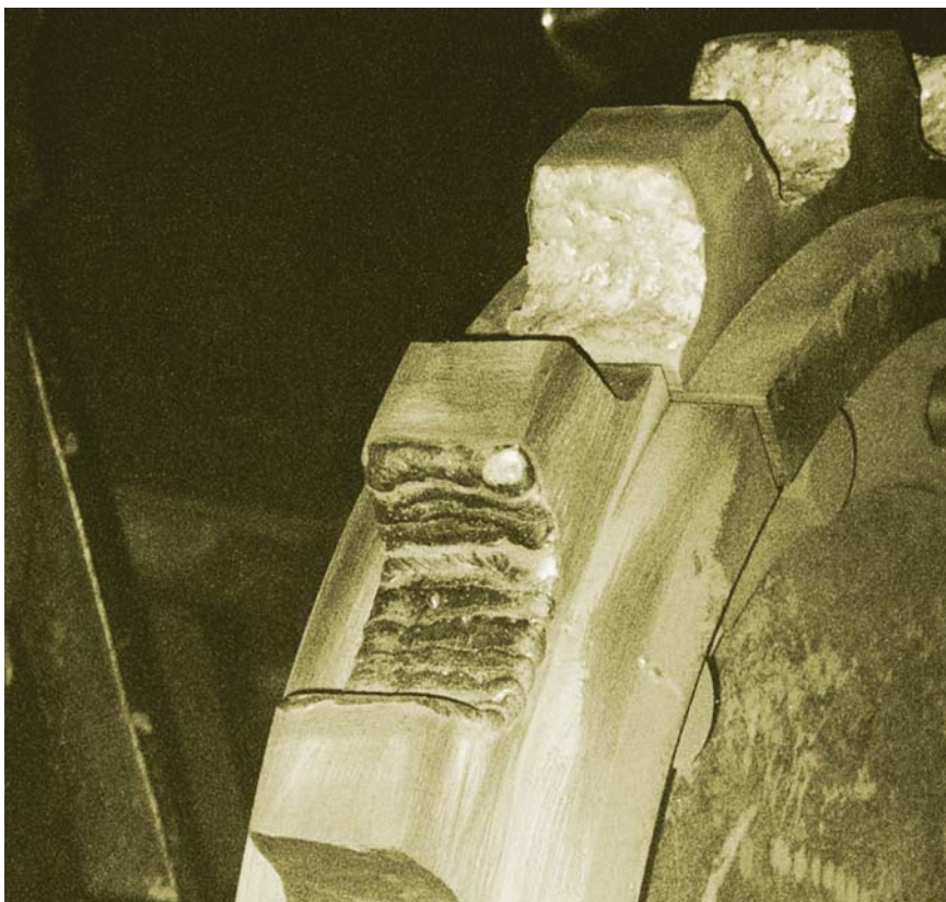
Hnací řetězové kolo: Preventivní údržba, elektroda OK 83.28
