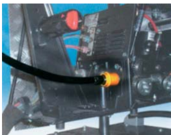
Instalace je snadná a rychlá, zde dokumentováno u typu Mini Marathon Pac. Vedení drátu je připojeno pomocí rychlospojky na víku a na podavači drátu.
