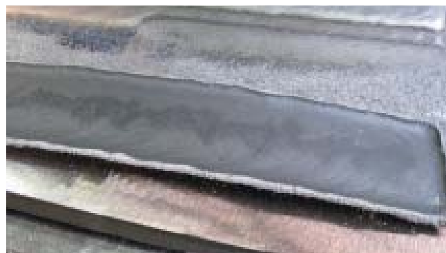
OK Band NiCrMo3, 60x0,5 mm; Svařovací hlava A6 a svařovací zdroj ESAB A6, 2x LAF 1600 DC+, kontrolní jednotka PEH. Navařovací parametry: 750 A / 28 V / 12 cm/min; DC+
