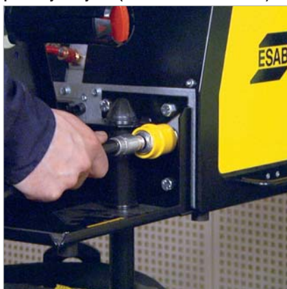
Krok 6: Připojte vedení drátu k podavači.
