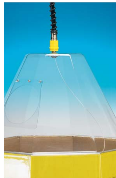
Krok 4: Zavřete sud kartonovým či plastovým víkem (Standard a Mini Marathon Pa™) nebo plastovým krytem (Jumbo Marathon Pac™).
