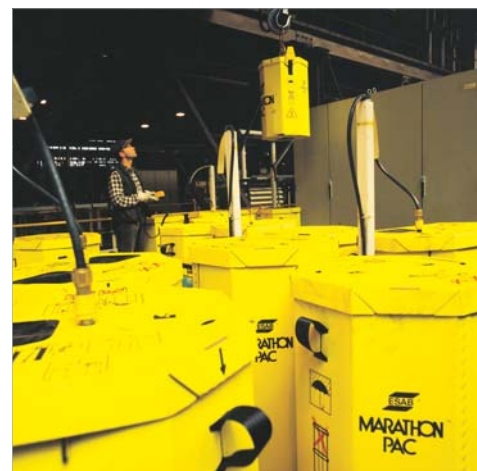
Jednoduchá manipulace balení Marathon Pac™ ke svařovací stanici za pomoci speciálního háku.
