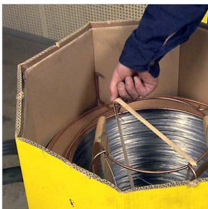
Krok 1: Odstraňte gumu a krycí papírové mezikruží.
