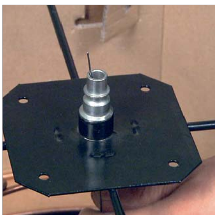
Krok 3: Provlákněte drát středem "spider".
