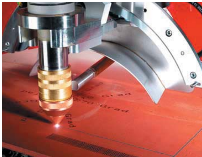
9| Značení plazmou bez nutnosti výměny nástroje a nebo spotřebních dílů
