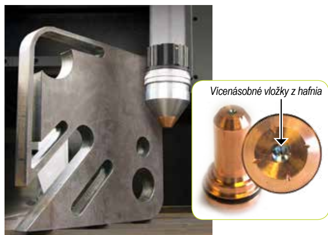
Technologie HeavyCut snižuje náklady při řezání měkké oceli o celý řád
